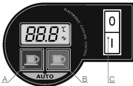
Der Dispenser ist auf dem Bedienelement mit einem Hauptschalter C ausgerüstet, dessen Funktion wie folgt sind:
