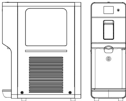
Attrezzatura professionale per la preparazione di gelato. Dotata di display touch e sensore presenza bicchiere.
